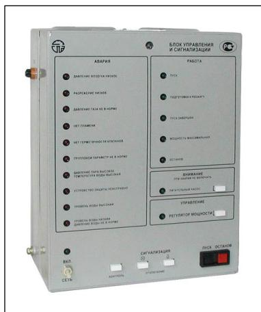
Блок управления и сигнализации БУС12 (в дальнейшем – блок) предназначен для автоматического управления тепловой установкой, работающей на газообразном топливе: паровым или водогрейным котлом малой мощности (до 3,0 МВт), горелками хлебопекарных, обжиговых печей, сушильных камер, агрегатов приготовления витаминной муки, теплогенераторов, устройствами розжига горелок установок средней мощности. Возможно применение блока для автоматизации тепловой установки, работающей на жидкое топливо.
