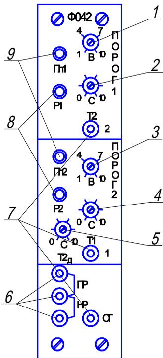
Рисунок 2 - Органы управления и контроля субблока Ф042
